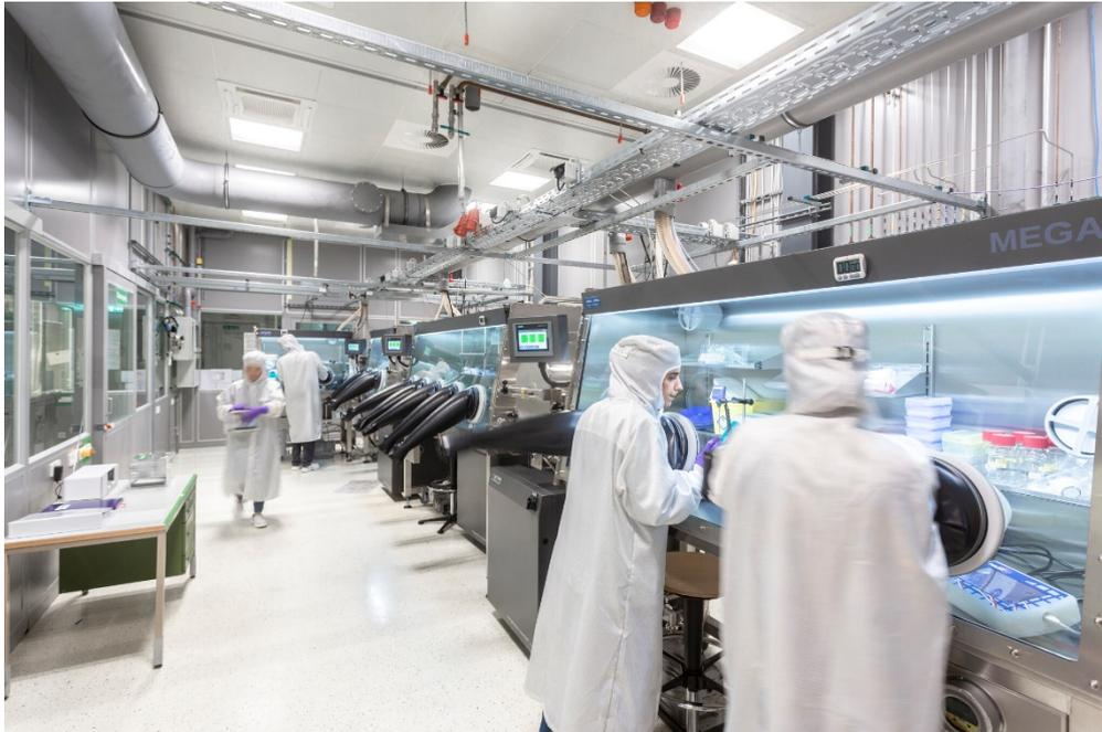
Prozessierung von Perowskit-Silicium-Tandemsolarzellen am Fraunhofer ISE. Die Infrastruktur umfasst Aufdampfkammern für Perowskitabsorber, selektive Kontakte und Metalle, sowie Atomlagenabscheidung von Metalloxiden unter Inertgasatmosphäre. © Fraunhofer ISE
